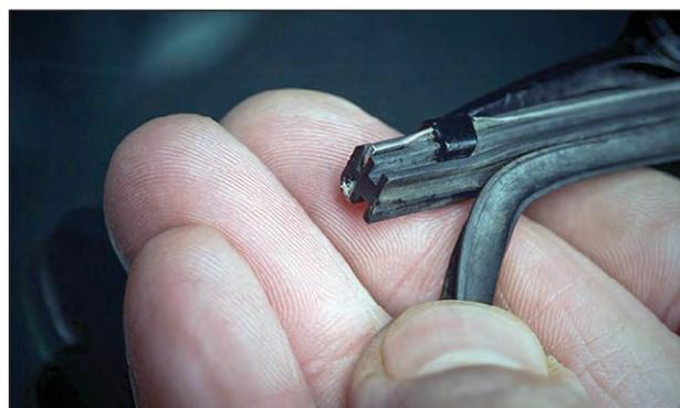
Une petite inspection de vos essuie-glaces, permettra de voir si le caoutchouc de ceux-ci est craqué ou endommagé. Ces derniers pourront donc être remplacés par des nouveaux, prêts à affronter les intempéries estivales.
