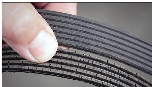
Les variations de température peuvent créer une usure prématurée de vos courroies. Une inspection rapide permettra de déceler les dommages.
